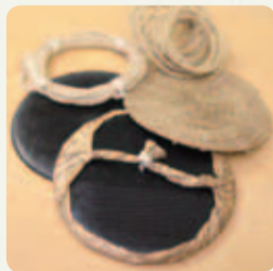
【本ばれん】 「ばれん」は摺る場面によって使い分ける。材質によって仕上がりが大きく異なり、「本ばれん」と呼ばれるものは福岡県八女市のカシロダケの皮を編み、芯が作られた最高級品。
